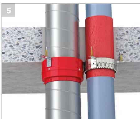
Kunststoffrohre mit einer PE-Schallschutzisolierung können mit dem ROKU® System EC Endless Collar zu einem Wickelfalzrohr mit einem Lüftungsschott im „Nullabstand“ montiert werden.
