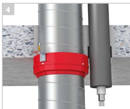
Ein „Nullabstand“ von Aluminiumverbundrohren mit einer Synthese-Kautschukisolierung zu einer Absperrvorrichtung gemäß DIN 18017 ist möglich.
