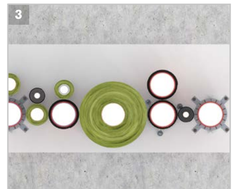
Eine zweireihige Montage der Abschottungssysteme ist möglich.
