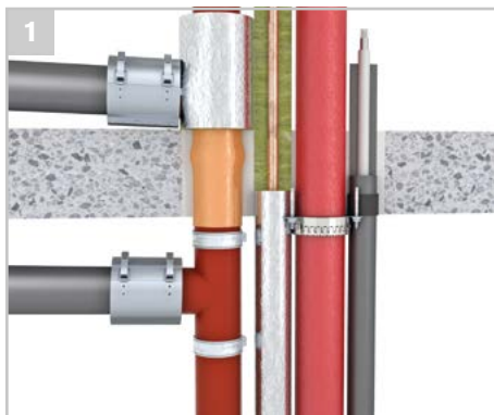
Verschiedenste Einbausituationen verschiedener Rohrtypen von Kupfer- bis hin zum Kunststoffrohr mit Synthese-Kautschukisolierung etc. werden mit dem ROKU® System Nullabstand abgedeckt.
